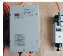
Eletromandril 2, 3, 4 ou 5HP com inversor de frequência, baixo ruído e velocidade até 18000 rpm com alto torque.
