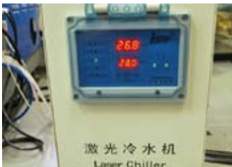
Resfriamento por chiller, garantindo maior estabilidade e durabilidade do canhão laser.
