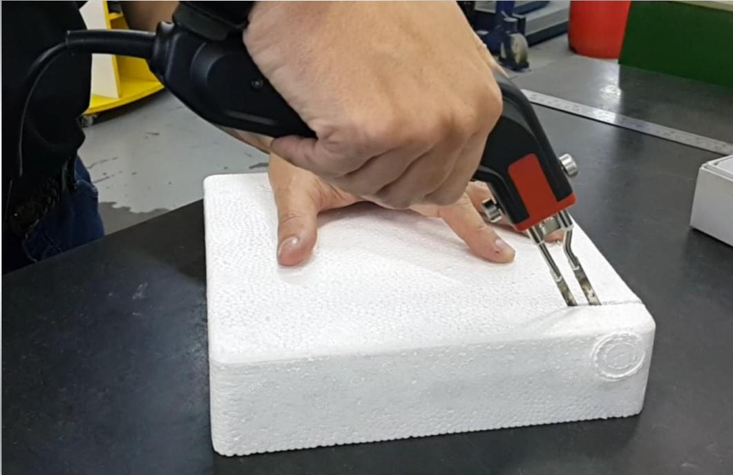
A cortadora a quente Engel Cutter é uma ferramenta robusta para trabalhos manuais de bricolagem para cortes de chapas de isopor de até 100mm, bem como cortes especiais (canaletas, vincos, etc).
